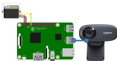
Gambar 2. Pemasangan Motor Servo dan Kamera Pada *Raspberry Pi*
